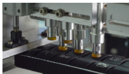
Botón del panel 1,2 millones de veces prueba de fiabilidad
