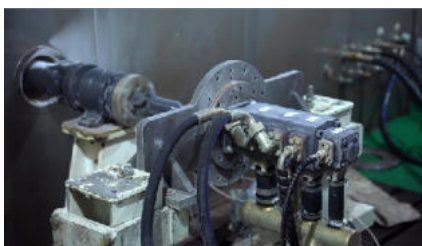
Bomba de aceite hidráulico Prueba de rendimiento a baja temperatura por debajo de -40 °
