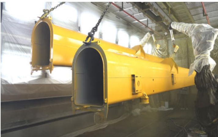
PROCESO DE PULVERIZACIÓN DEL ROBOT
