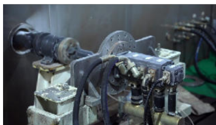
Bomba de aceite hidráulico Prueba de rendimiento a baja temperatura por debajo de -40 °C
